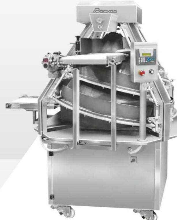
► Предназначен для создания однородной структуры тестовых заготовок, равномерного распределения и частичного удаления диоксида углерода, заделки поверхностных пор и придания заготовкам шарообразной формы при работе в технологических линиях по производству широкого ассортимента хлебобулочных изделий.
