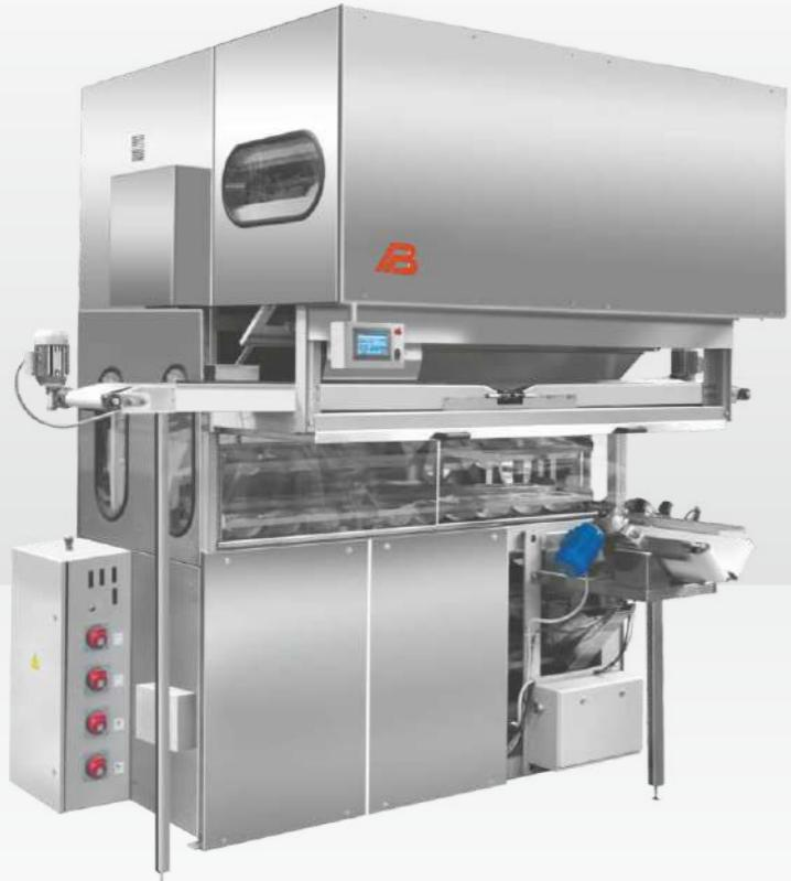
► Предназначен для механизации процесса предварительной расстойки тестовых заготовок хлебобулочных изделий непосредственно после их округления в технологических линиях по производству хлебобулочных изделий.
