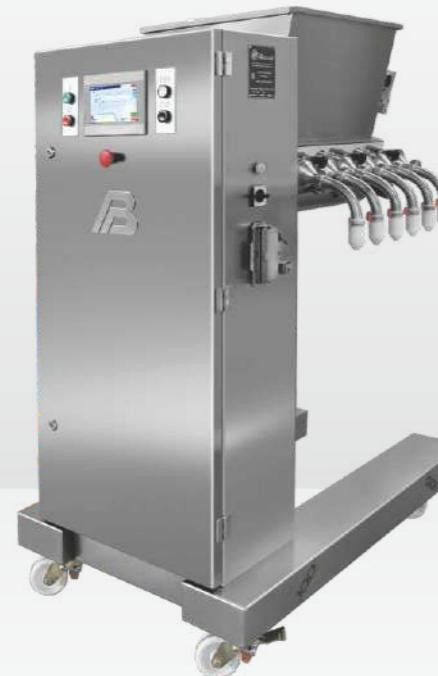
► Предназначен для нанесения начинки на тестовые заготовки. Нанесение производится в процессе безостановочного движения их на транспортерной ленте и движения с остановками.
