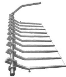
Механизм струнной резки
