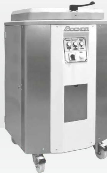
► Предназначен для бережного деления взвешенной порции теста на двадцать заготовок одинаковой массы из пшеничной муки влажностью не менее 41% для батонов, багетов и чиабатты. Возможно формирования пластов маргарина при использовании плиты для прессования (опция).
