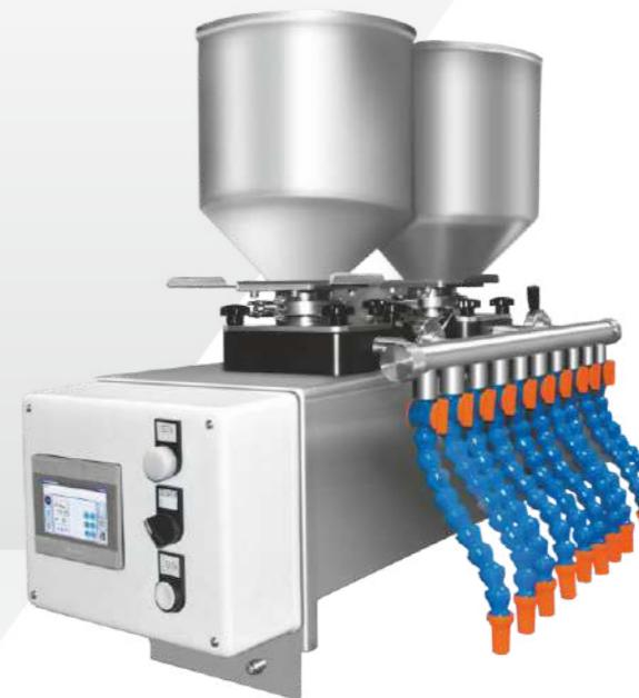
► Дозатор предназначен для работы как в составе стола нарезочного «Восход-СН» 3500, так и с другими столами нарезочными и служит для дозирования начинки (фруктовый джем, заварной крем, маковая начинка) на тестовые заготовки кондитерских изделий.
