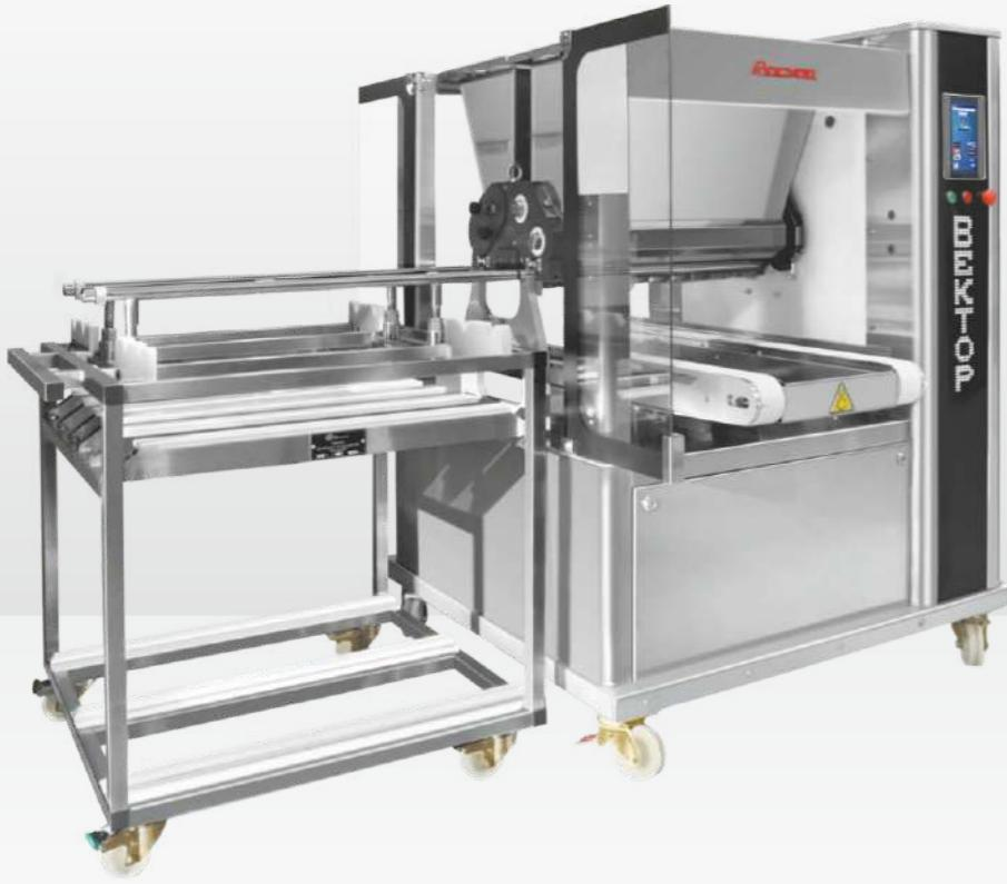
► Предназначена для формования на противни методом экструзии тестовых заготовок кондитерских изделий различной формы и размеров. Машина предназначена для работы с различными видами кондитерских смесей и теста разнообразной консистенции: песочным (твердым или мягким), белковым, бисквитным, заварным (эклеры, профитроли, кольца), зефирам (на агаре), овсяным, сырцовым пряничным (приготовленным на холодном сиропе).
